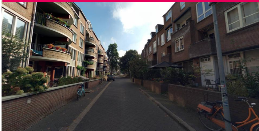
Figuur 6.8: Fysieke barrières en te smal profiel o.a. door de stenen muurtjes evenals hoogteverschillen
